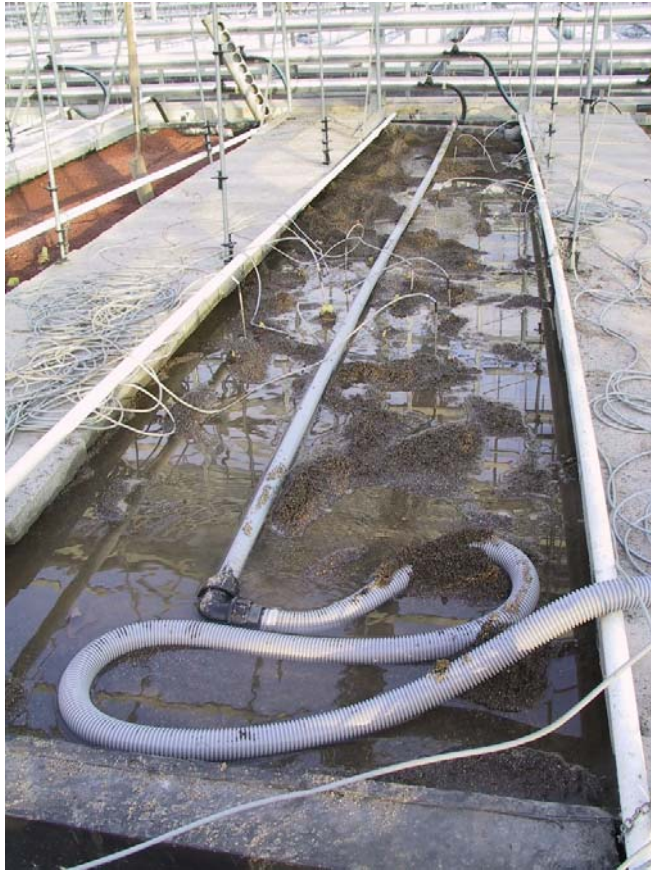
Figuur 11: Waterophoping in een bed met flugzand bij onvoldoende drain. Het water hoopte snel op waardoor het over het flugzand heen naar het afvoerpunt stroomde.
