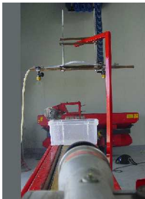
Foto Spraytoweropstelling: Een transportband leidt het te bespuiten object (hier kunststofbakken) onder een vast opgestelde spuitboom door.
