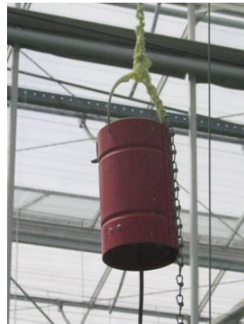
Figuur 2. Zwavelverdamper en zwavelpijp
