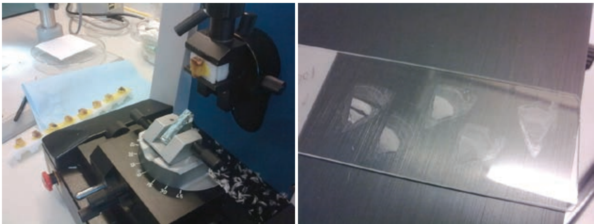
Figuur 5.1: Het snijden van de coupes met een microtoom
