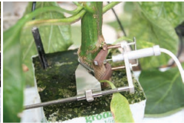
Figuur 6.1: Stengeldikte meter en wetsensor bij de start van de meting mei 2012
