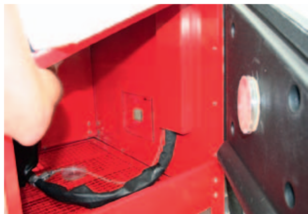
Figuur 7. Straalkabine, met geïnoculeerde glasplaat tegen de achterwand en vangplaten op de vier wanden van de cabine.
