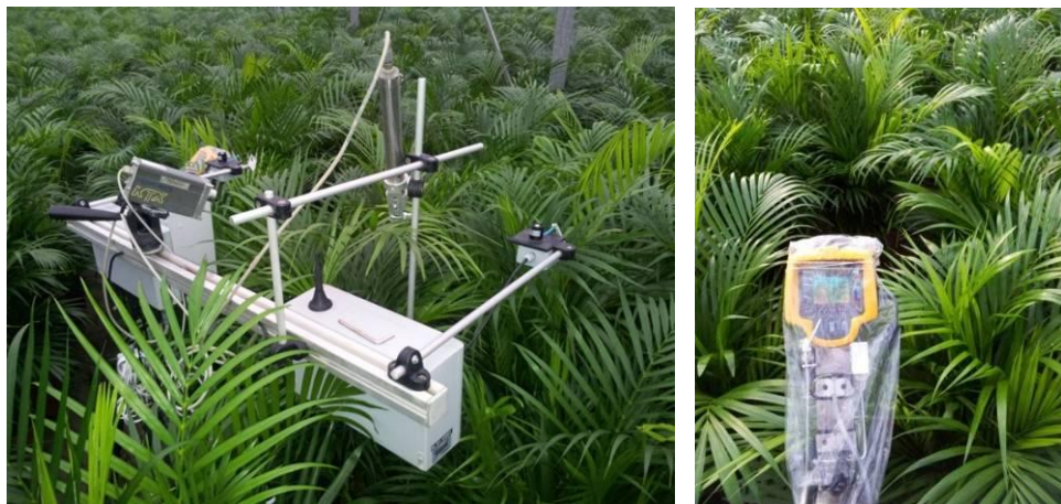
Figuur 3 GrowWatch en thermografische camera in Areca Palm
