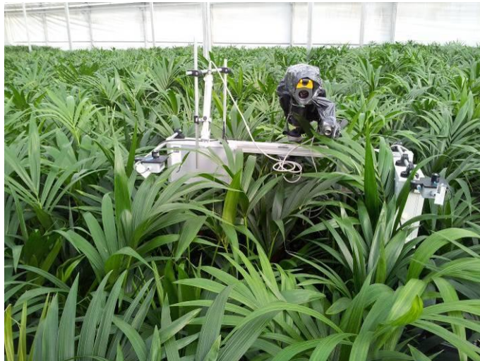
Figuur 2 GrowWatch en thermografische camera in Kentia Palm
