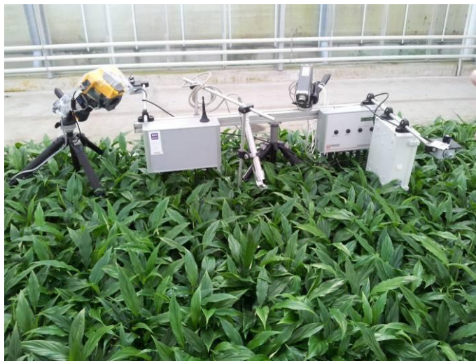
Figuur 1 GrowWatch en thermografische camera in spathiphyllum Yess 9 cm.
