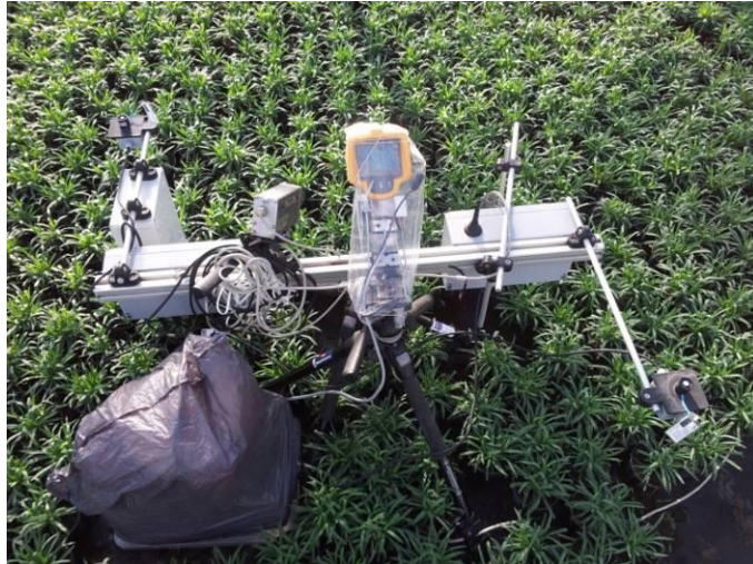
Figuur 4 GrowWatch en thermografische camera in pot anjer
