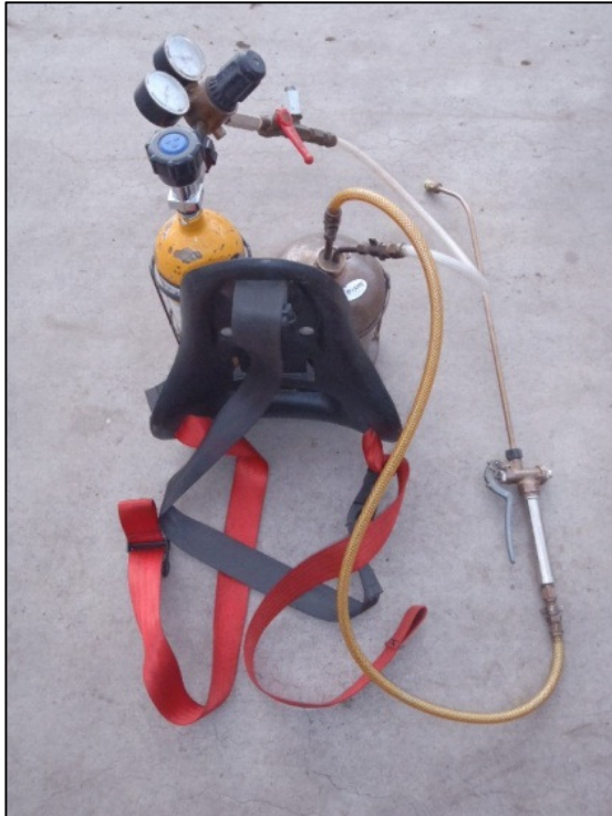
Figuur 2.2: Handgedragen perslucht ondersteunde proefveldspuit
