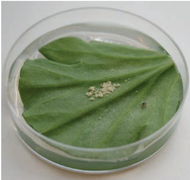
Figuur 3.4. Opzet laboratorium proeven: ontwikkeling en overleving van nimfen. De proeven zijn uitgevoerd in petrischalen met bladpensen chrysant op agar. Per schaal is één pas uitgekomen Orius nimf gekweekt met één van de geteste diëten. Jonge nimfen zijn 3 maal per week gemonitord om de overleving te bepalen. Nimfen die de volwassen stadium naderden zijn dagelijks gemonitord om de ontwikkelingstijd tot adult te bepalen.
