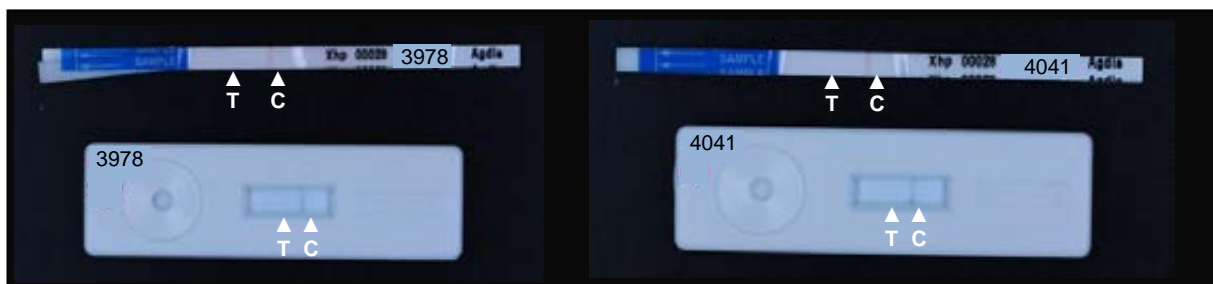
Figuur 23. Resultaten sneltesten van Agdia en Pocket Diagnostics; C = controle, T = test ( X.h.pel. ) met isolaten Xanthomonas campestris NBC 3978 en NBC 4041, beide geïsoleerd uit aangetast blad van Pelargonium zonale . De sneltesten reageren niet met Xanthomonas campestris uit Pelargonium , er is geen test-bandje te zien.
