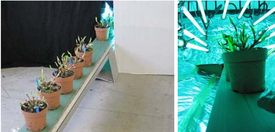
Foto 4: Links: De planten gaan middels een transportbaan de UVc-licht-kamer in. Rechts: Het UVc-licht komt door een ronde positie van de lampen en door reflectie rondom op de plant.
