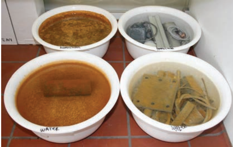
Figuur 10: Resultaat van de corrosieproef na 31 dagen. Verschillende materialen na 31 dagen ondergedompeld te hebben gelegen in water (voor) en het oxidatief product (achter). Links zijn de stukken onverzinkt ijzer zichtbaar en rechts de overige materialen.
