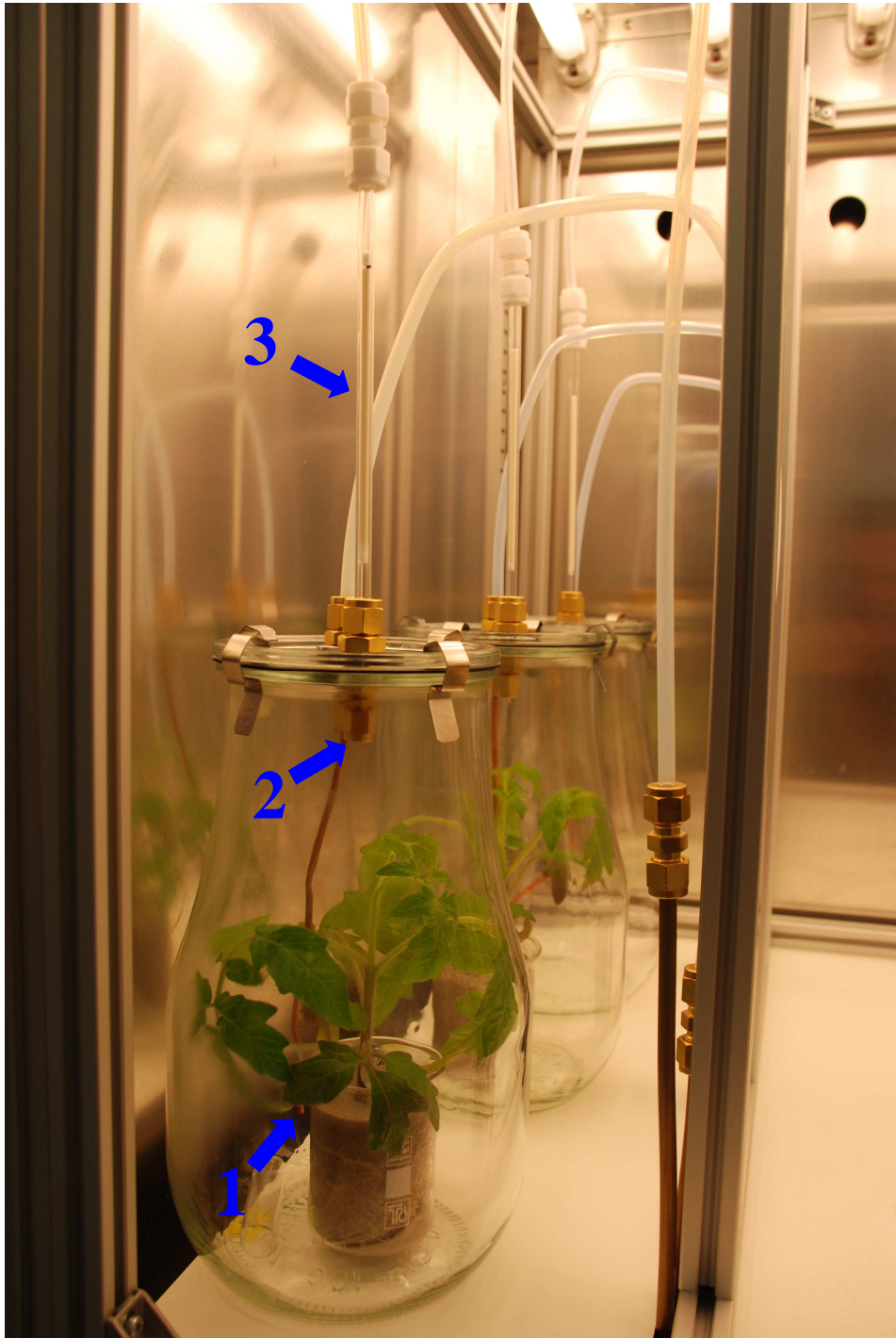
Figuur 1: Opstelling headspace collectie. 1=inlet gefilterde lucht; 2=exit lucht; 3=Tenax/superQ buis voor invangen geurstoffen
