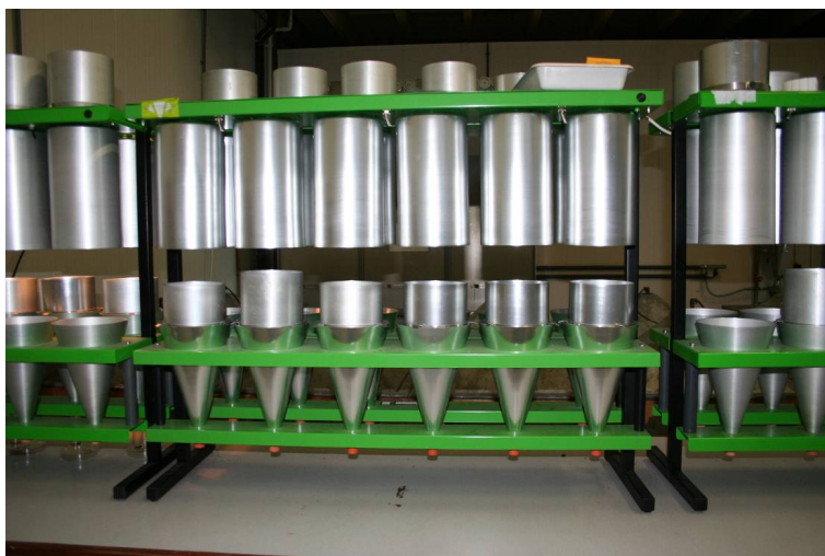
Figuur 9. Tullgrenapparatuur voor uitdrijven van bodemfauna.
