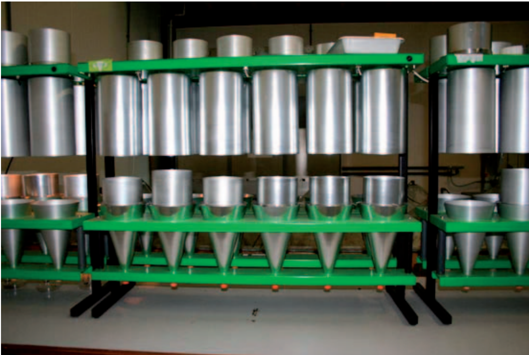
Figuur 13. Tullgrenapparatuur voor uitdrijven van (bodem)fauna
