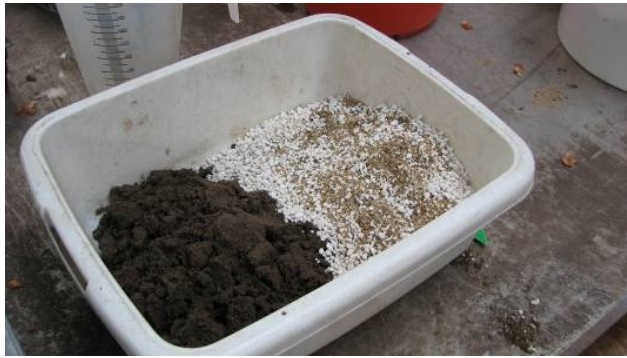
Mixen van te testen grond met zand/Perlite mix
