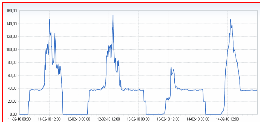
Figuur 9: Belichting; 11-02 ochtend, 12-02 overgang en 13-02 avondbelichting. De rasterlijnen staan op 00:00 en 12:00 uur (gemeten als PAR; \mu\text{mol}/\text{m}^2.\text{sec} op de linker-as)
