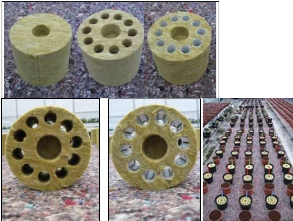
Figuur 3. Steenwolpotten die werden getest in dit project. Linksboven is de controle pot te zien, met in het midden het plantgat voor een steenwolplug met jonge plant. In de steenwol pot boven in het midden, zijn rond het plantgat tien gaten gemaakt (zie ook linksonder). In de steenwolpot rechtsboven zijn in die 10 gaten rondom, PVC pijpjes geplaatst (zie ook middenonder). Rechtsonder is een opname vlak voor de planten op de steenwolpotten werden gezet.
