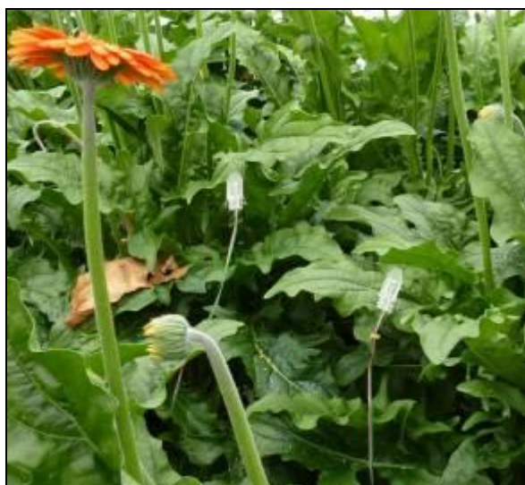
Figuur 19. Bladdiktesensoren op jong volgroeide bladeren van planten in de zandbeddenproef.
