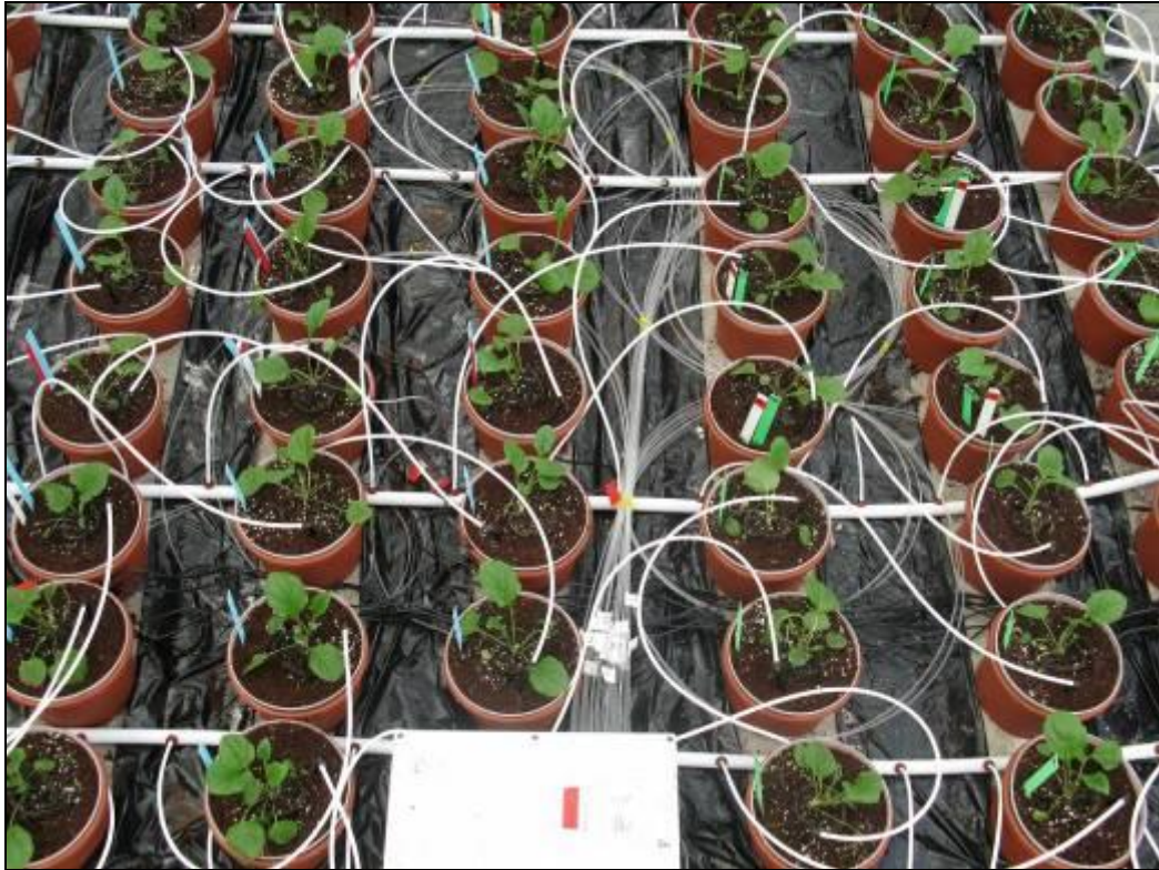
Figuur 10. Bovenaanzicht van Gerbera planten op fijn kokos op zandbedden. Onderaan de foto is een zuurstof meetbox te zien, waaruit 20 fibers komen die de zuurstof in het substraat meten.
