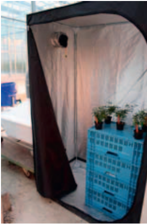
Figuur 5.15. Behandelruimte die gebruikt is voor de proeven met potroos en Poinsettia planten. Links van de tent is de Aquanox-machine opgesteld die linksboven de nevel in de tent blaast. De behandeltime gaat in als de ultrasone nevel de tent volledig heeft gevuld (rv>90%).
