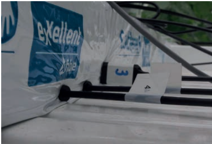
Figuur 12. Optische Zuurstof en pH sensoren, ingestoken in steenwolsubstraat.
