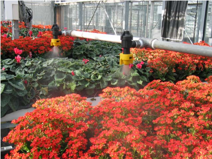
Figuur 20. Met de spuitboom wordt de spuitvloeistof boven op het gewas gespoten.
