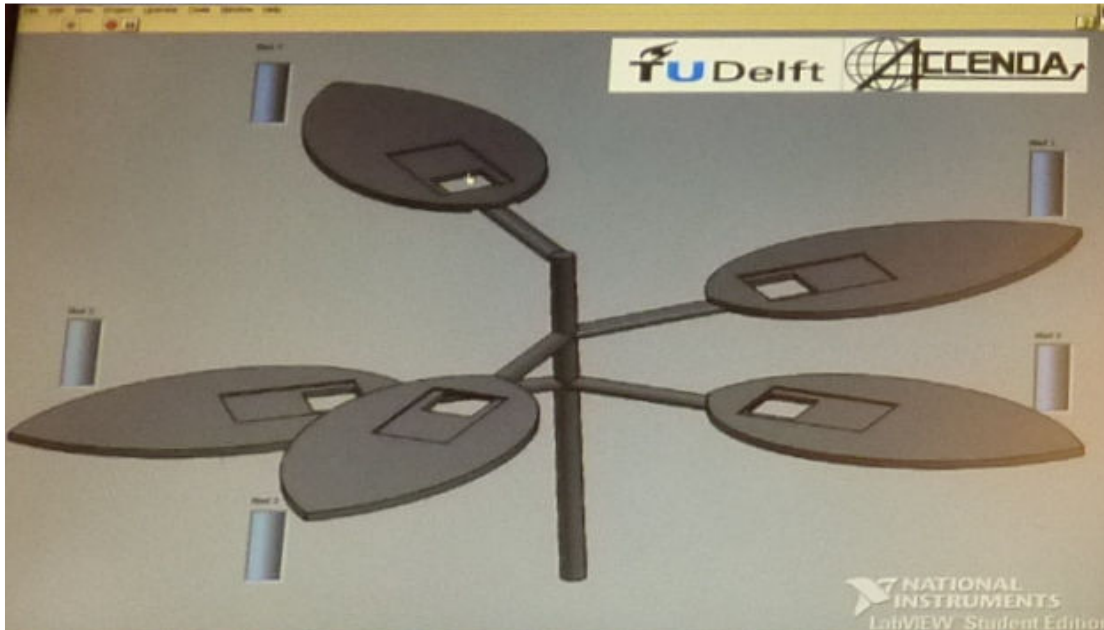
Figuur 4. Schermpresentatie van bladvochtigheid op de testinstallatie.
