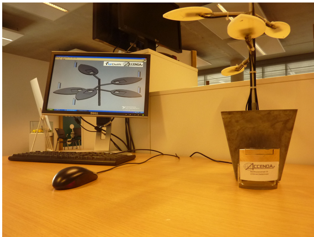
Figuur 7. Demo van spuitsensorinstallatie met beeldschermpresentatie van bladvochtigheid – op Floriade 2012.
