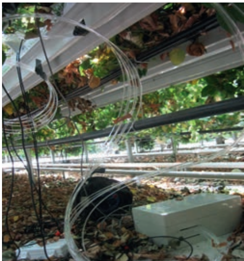
Figuur 6. Meetopstelling met optische zuurstofsensoren.
