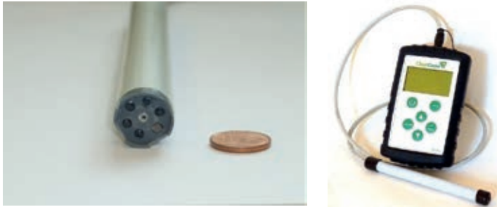
Figuur 8. De eerste foto toont de sensorkop met daarin opgenomen 6 ion sensoren en een referentie sensor. De tweede foto toont een handheld meetapparaat.
