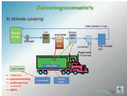
Figuur 16. mobiele installatie voor RO/MD.
