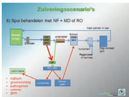
Figuur 15. Spuiwater behandelen met NF en RO of MD.
