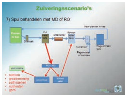
Figuur 14. Spuiwater behandelen met RO/MD.
