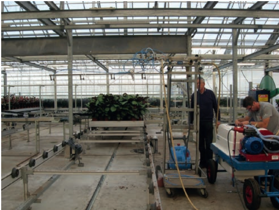
Figuur 11. Rolcontainer beweegt heen en terug langs de spuitopstelling.
