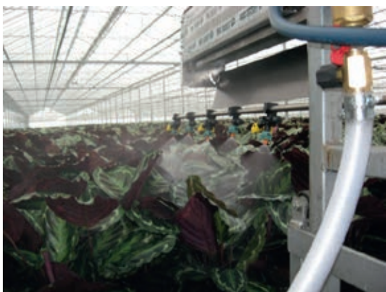
Figuur 8. Luchtgordijn achter spuitboom.
