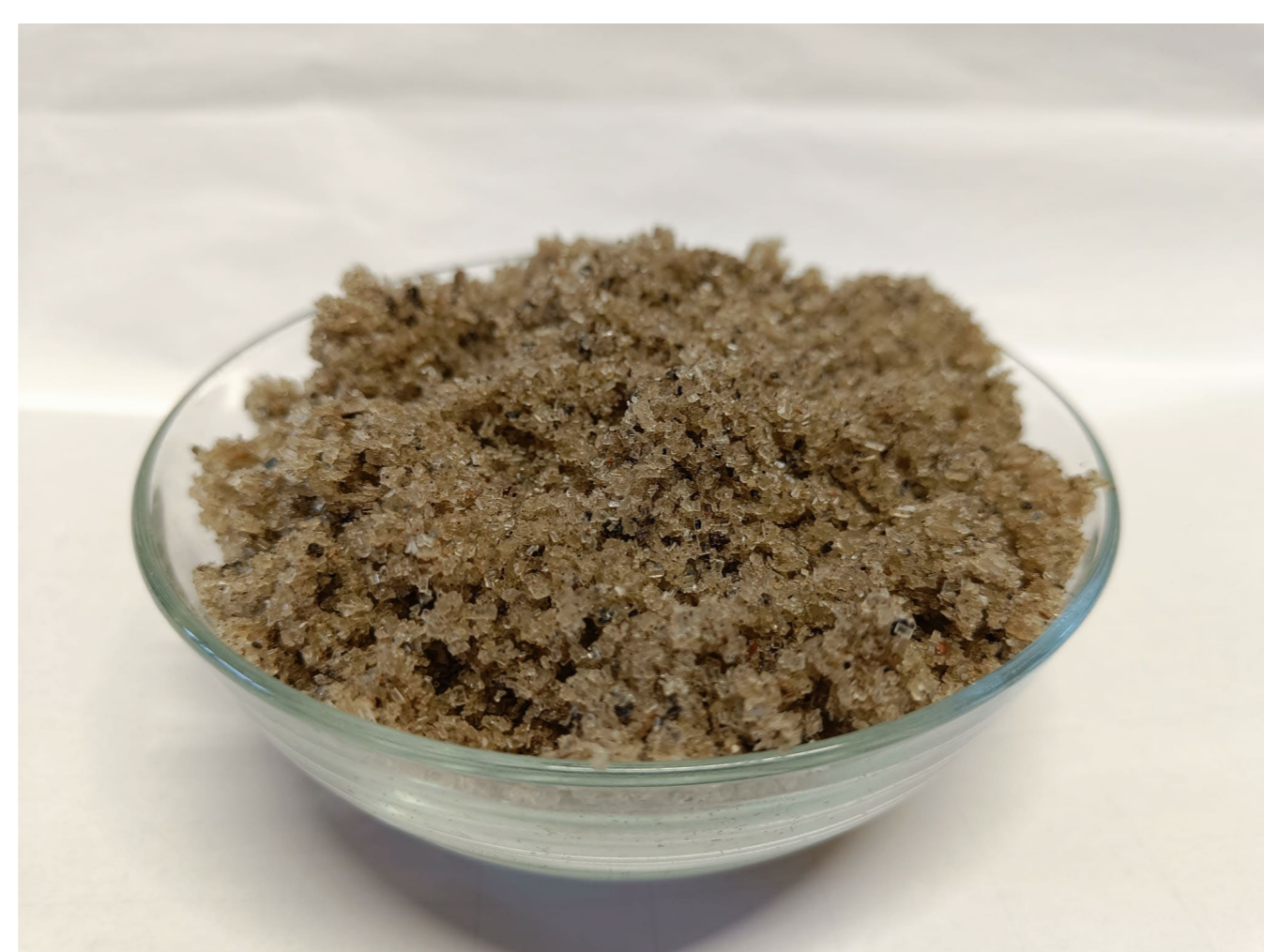
Struviet ( \text{NH}_4\text{MgPO}_4 \cdot 6\text{H}_2\text{O} ), een bron van fosfor maar ook magnesium, van Waternet.
